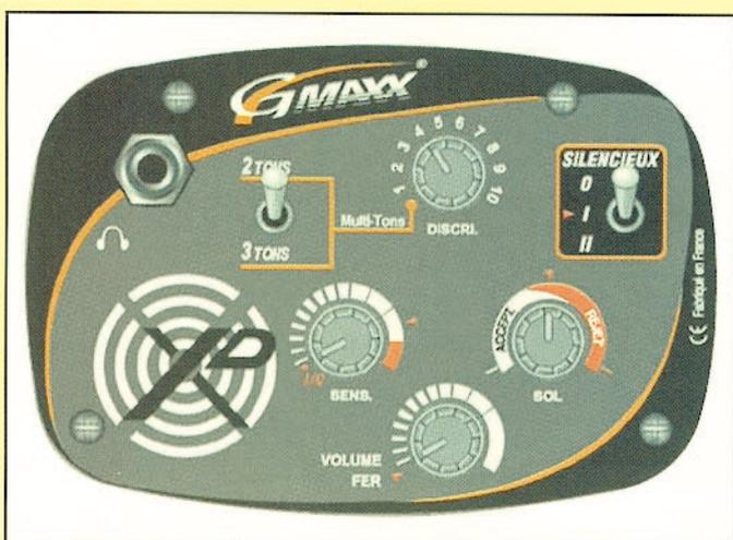
La face supérieure du boîtier du *G MAXX* avec les principaux réglages qui servent les deux machines testées. Ce tableau de bord présente quelques innovations intéressantes par rapport à d'autres appareils traditionnels sans vumètre d'analyse.
